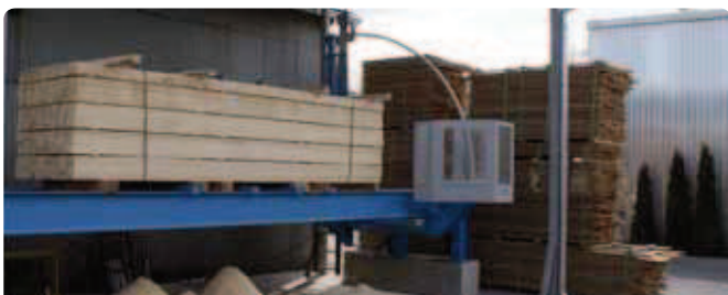
Jednostkę tnącą napędzaną manualnie (korbę) zatrzymuje się na żądanej długości, wskazanej na wyświetlaczu cyfrowym.
