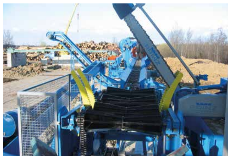
LOGSTAR combi firmy PRINZ łączy się z transporterem podawczo-odbiorczym za pomocą łańcuchów napędowych.
