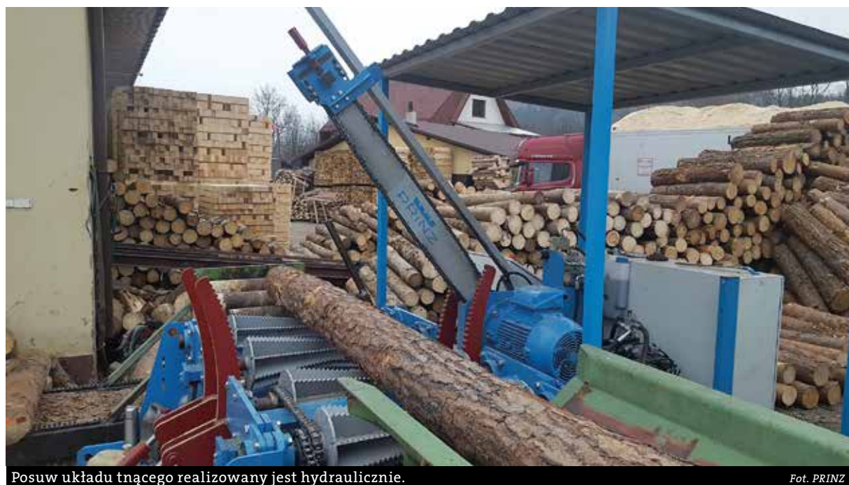
Posuw układu tnącego realizowany jest hydraulicznie.
