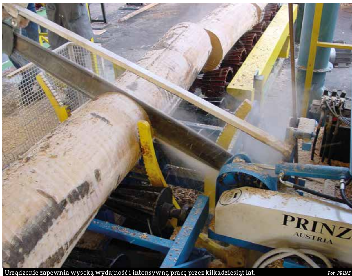
Układ tnący w urządzeniu to masywny, żłobikowy łańcuch LOGMAX, zapewniający wydajne kapowanie i bezproblemową pracę.
