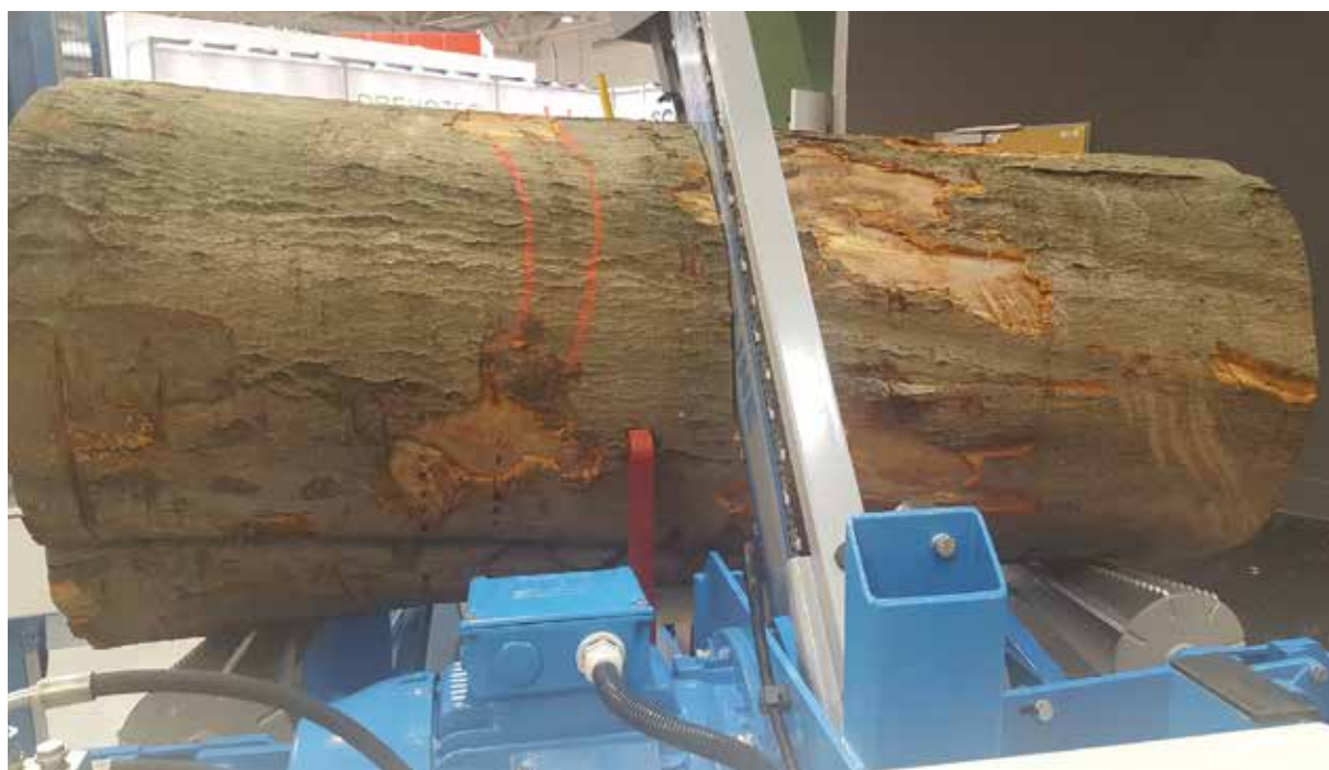
Stacja kapowania drewna okrągłego pracuje z surowcem o dużych średnicach.
