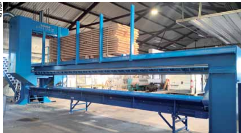
Pakiet dosuwany jest za pomocą wózka widłowego do pionowych profili pozycjonujących.
