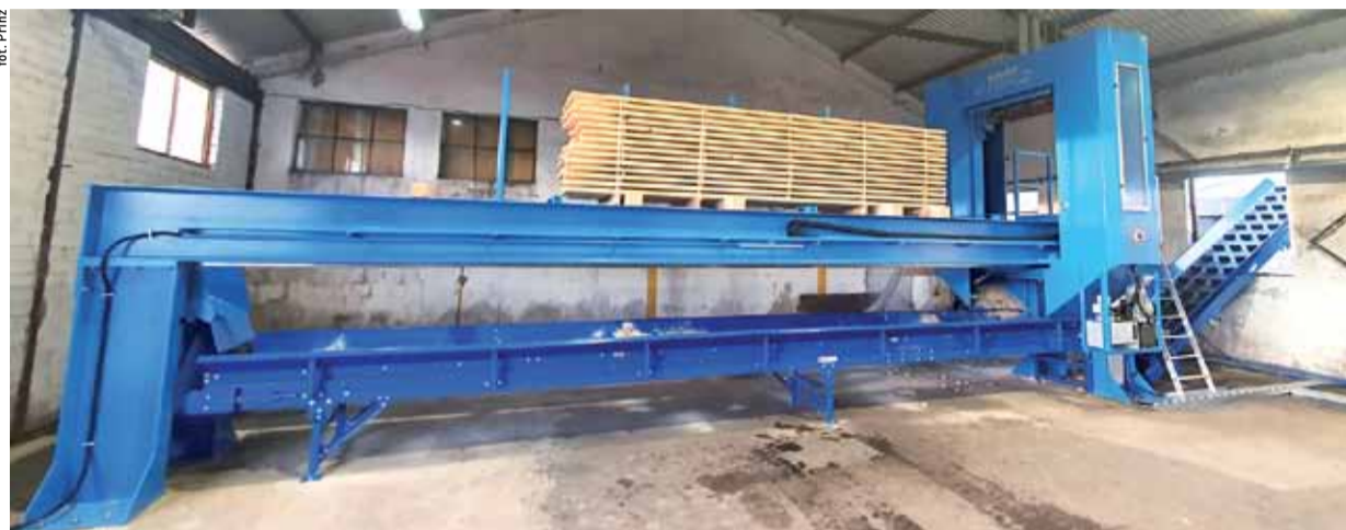
Zainstalowana w ZPD Drawsko Pomorskie wysokowydajna stacja kapowania pakietów Cutstar, z przejezdną jednostką tnącą.
