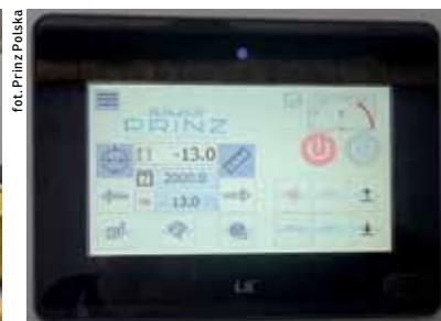
Panel dotykowy pozwala na zaprogramowanie ośmiu długości cięcia.
