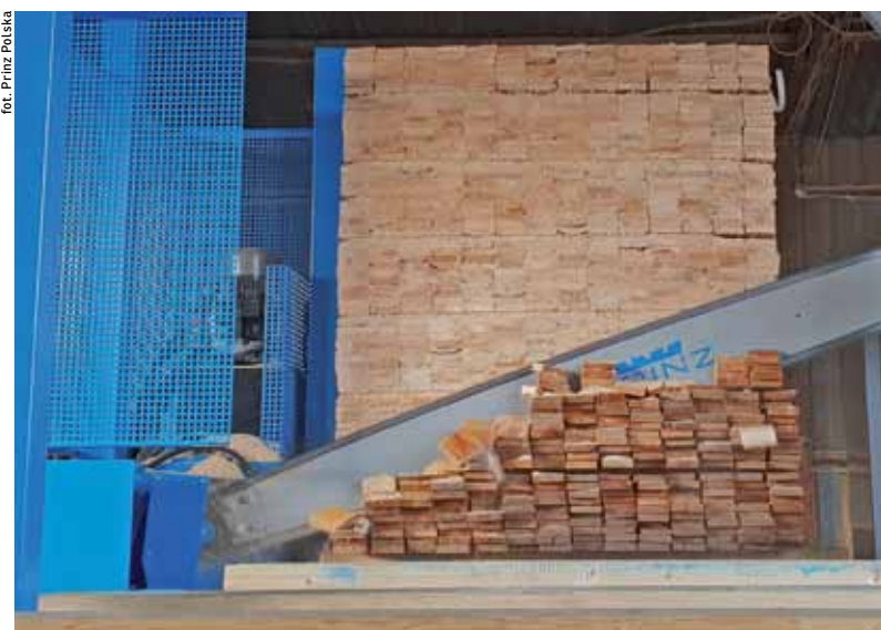
Idealnie gładka powierzchnia pakietu po cięciu to zastuga przemysłowych łańcuchów tnących o podziatce 15 i 20 mm.
