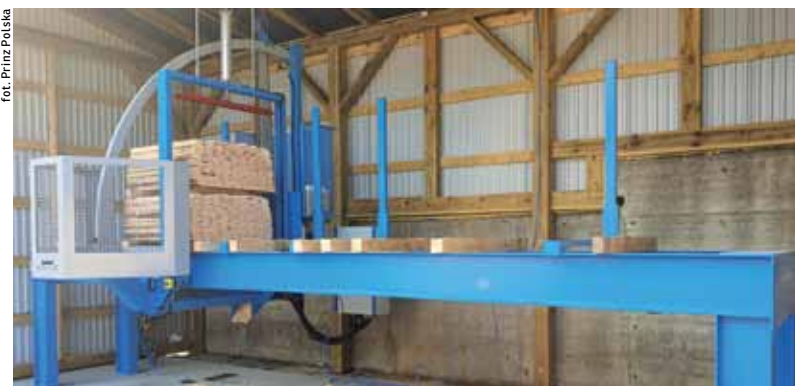
Stacja kapowania pakietów Mobilcut Top Line w firmie Dremwex.
