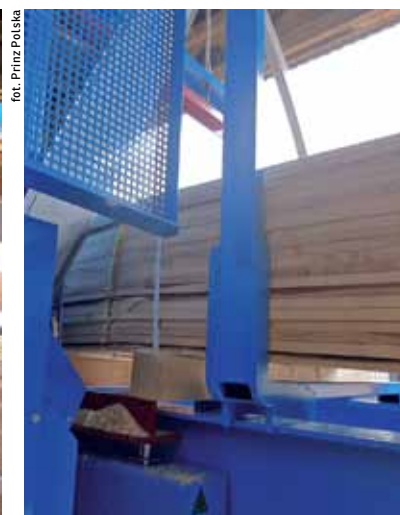
System „otwierania” rzazu lekko unosi docięte pakiety i umożliwia bezproblemowe wycofanie prowadnicy.
