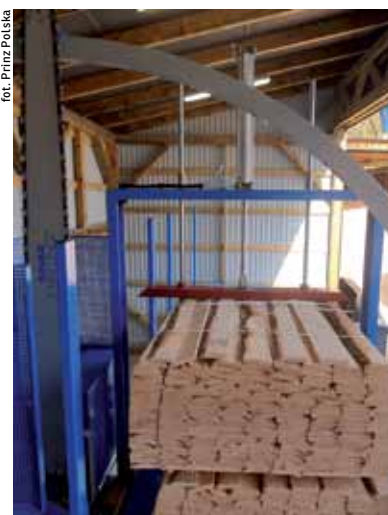
Pneumatyczny docisk stabilizuje pakiet podczas cięcia.
