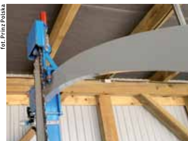
Masywny łuk prowadzący zapewnia dużą dokładność cięcia.
