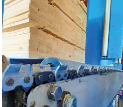
Zdj. 5. Łańcuchy typu OPTICUT, PROCUT oraz MULTICUT charakteryzują się prostymi ogniwami tnącymi, które pozostawiają powierzchnię po cięciu gładką i idealnie równą oraz umożliwiają uzyskanie dokładności cięcia na poziomie +/- 1 mm.
