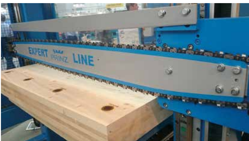
Zdj. 4. Prowadnice EXPERT LINE charakteryzujące się najdłuższą żywotnością i odpornością na najtrudniejsze warunki podczas cięcia, stosowane w wysokowydajnych liniach kapowania.
