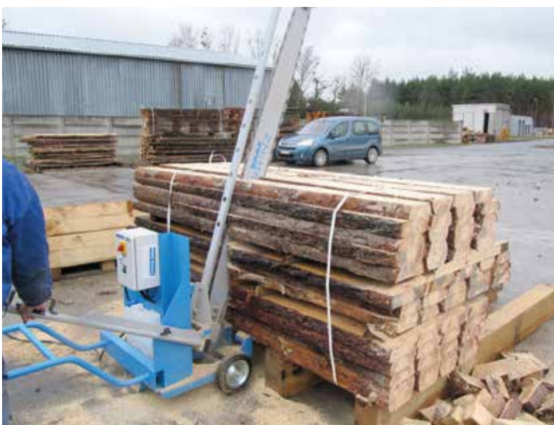
Zdj. 2. ECOSTAR powstał w odpowiedzi na liczne zapytania ze strony mniejszych zakładów drzewnych o tańsze piły do kapowania pakietów i drewna okrągłego.
