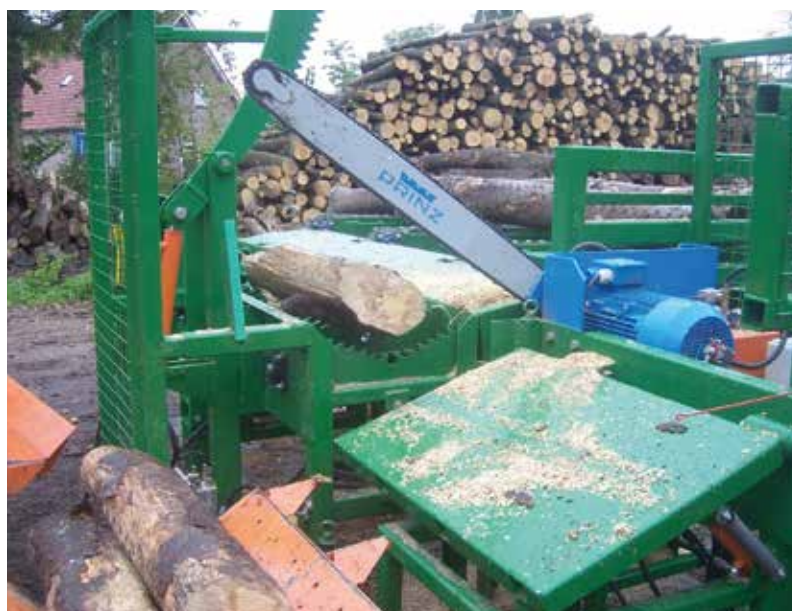
Zdj. 3. UNI BLOCK - układ tnący przystosowany do pracy w linii manipulacji o większej wydajności.
