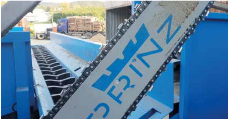
Zdj. 6. Do kapowania drewna okrągłego klienci najczęściej wybierają chromowane łańcuchy żłobikowe typu LOGMAX oraz TIMBERCUT z zaokrąglonymi zębami, umożliwiające szybkie cięcia i wydajną pracę piły, przy minimalnych kosztach ostrzenia.
