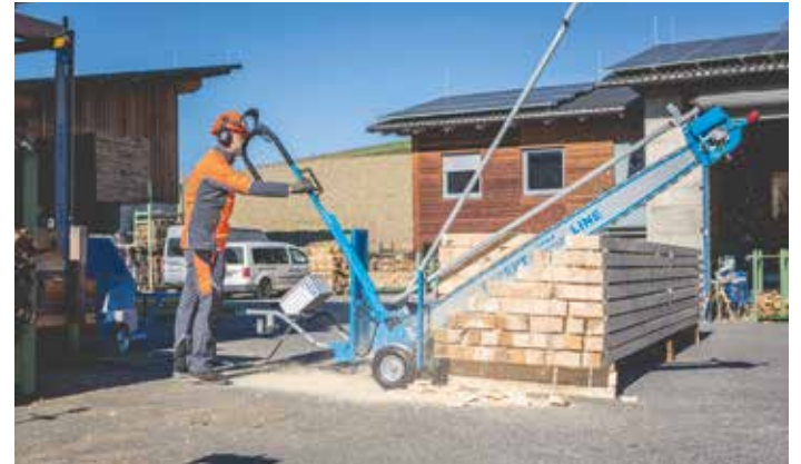
Zdj. 1. Jednoosobowa piła elektryczna PROFICUT light do kapowania pakietów desek, płyt i drewna okrągłego.
