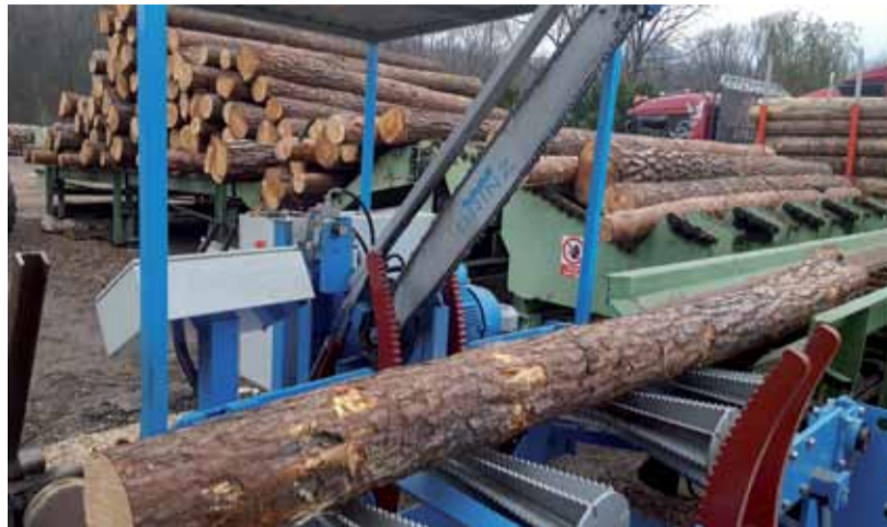
Dłuższe dzięki separatorowi schodowemu trafiają na przenośnik łańcuchowy wzdłużny.
