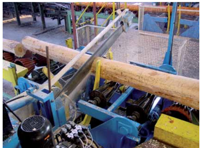
Logstar combi wyposażona jest w system umożliwiający odpowiednie ustawienie położenia krańcowego układu tnącego.
