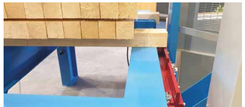
Pneumatyczny system otwierania rzazu po cięciu. Fot. PRINZ
