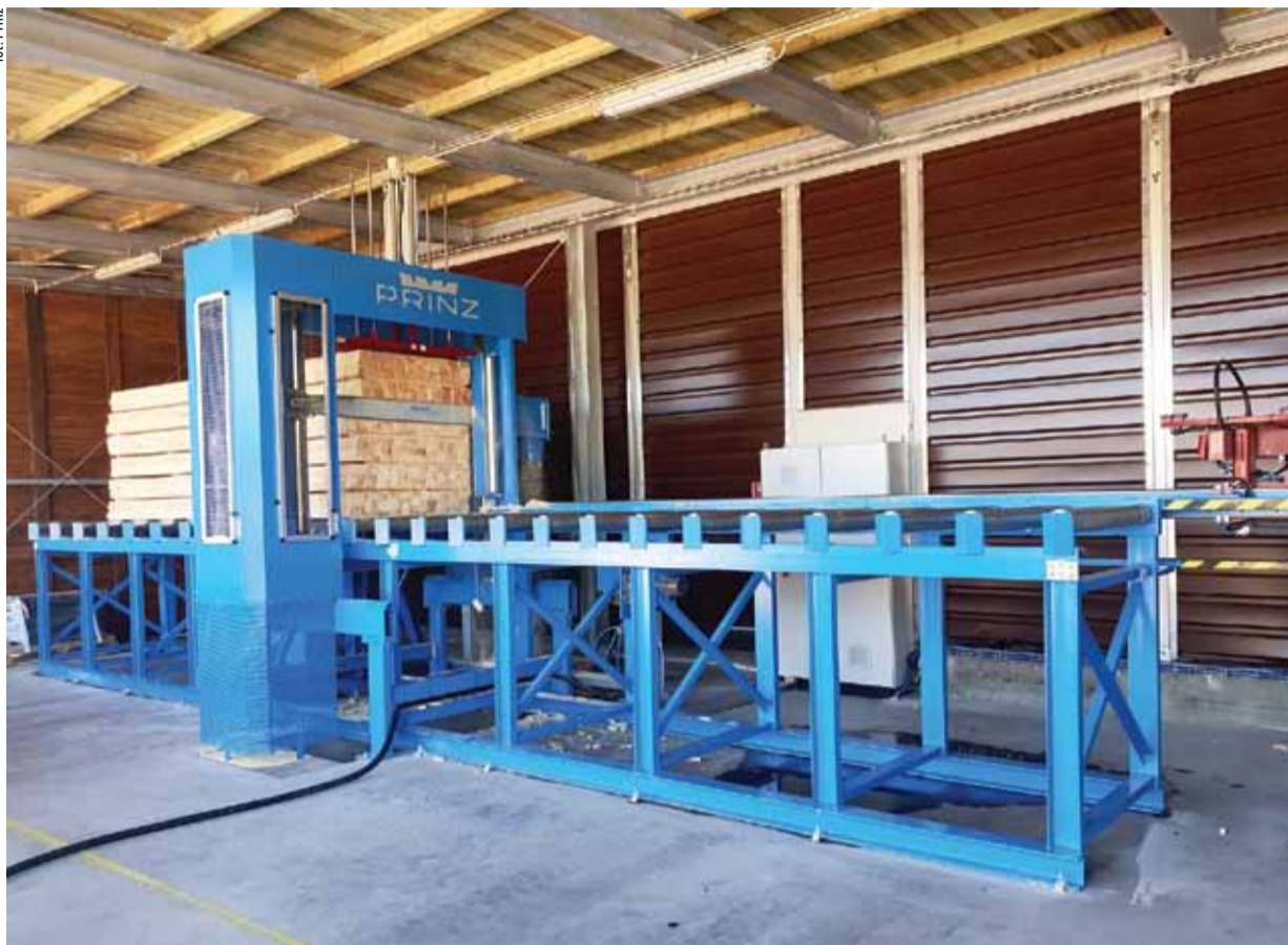
Linia kapowania pakietów PC 120 ze stołem rolkowym, zainstalowana w Tartaku NARA.
