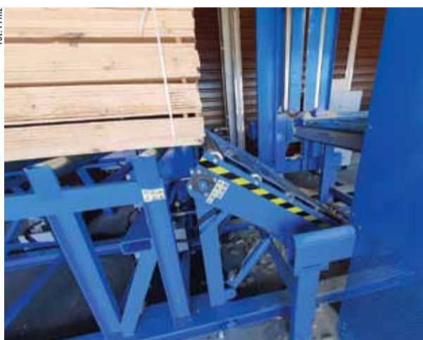
Uchylny, hydraulicznie sterowany stół rolkowy ułatwia odprowadzanie odciętych dłuższych kawałków drewna na wibrorynnę.
