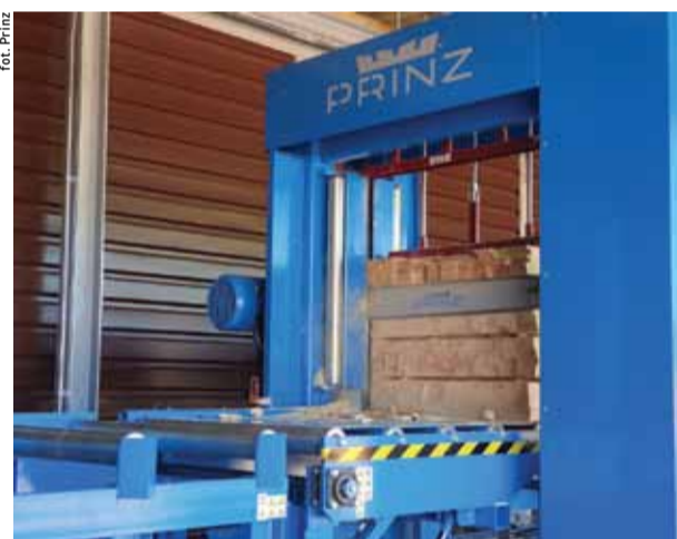
Masywna jednostka tnąca wyposażona jest w liniowe prowadzenia układu tnącego.
