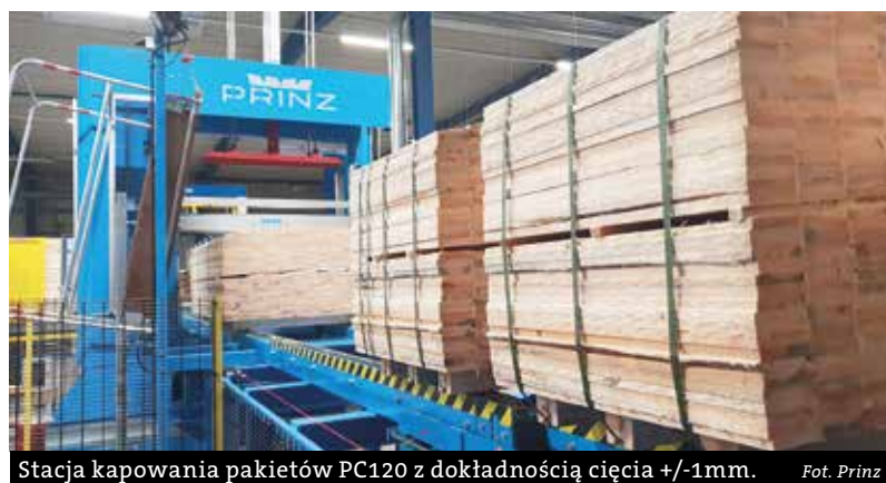
Stacja kapowania pakietów PC120 z dokładnością cięcia +/-1mm. Fot. Prinz
