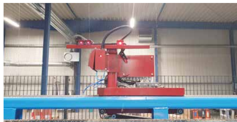
Automatyczny, niezależnie napędzany układ pomiarowy zamontowany przy stole odbiorczym pakietów. Fot. Prinz
