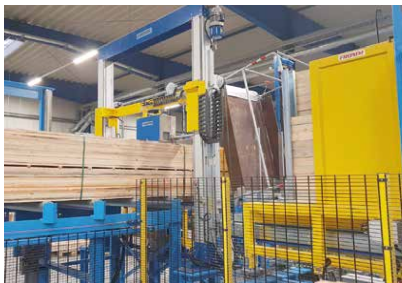
Automatyczna obwiązywarka pakietów taśmami z tworzywa z magazynem kantówek umieszczanych pod pakietem. Fot. Prinz
