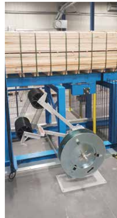
Spięty z podkładami pakiet transportowany na przenośniku łańcuchowym pod stację kapowania. Fot. Prinz
