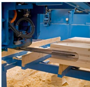
Precyzyjne cięcia zagwarantowane są przez łańcuchy tnące PRINZ, które dają gładkie i równe wycięcia.
