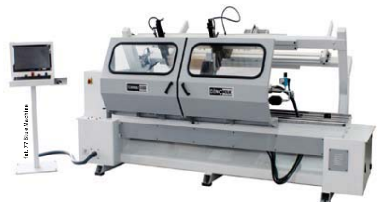
Przyrządy nadające kształt elementom znajdują się po jednej stronie osi, natomiast po drugiej umieszczono poziome i pionowe narzędzia frezarskie.
