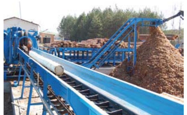
Dłużyce są przenoszone do stacji Logstar przenośnikiem łańcuchowym.
