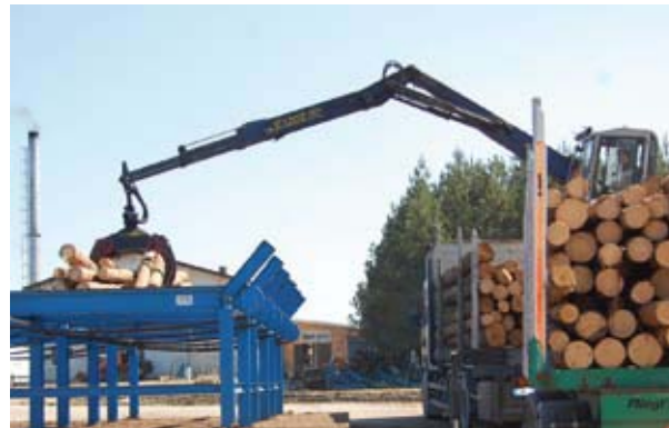
Dowózony surowiec jest rozładowywany na rampę z przenośnikami łańcuchowymi.
