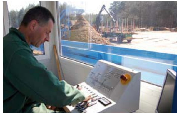
Pracę linii i stacji kapowania steruje operator z zamkniętego pomieszczenia.
