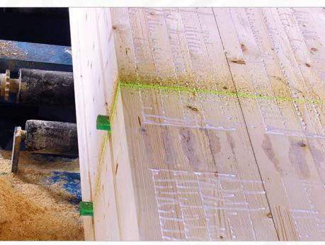
+ Лазерная проекция резки
