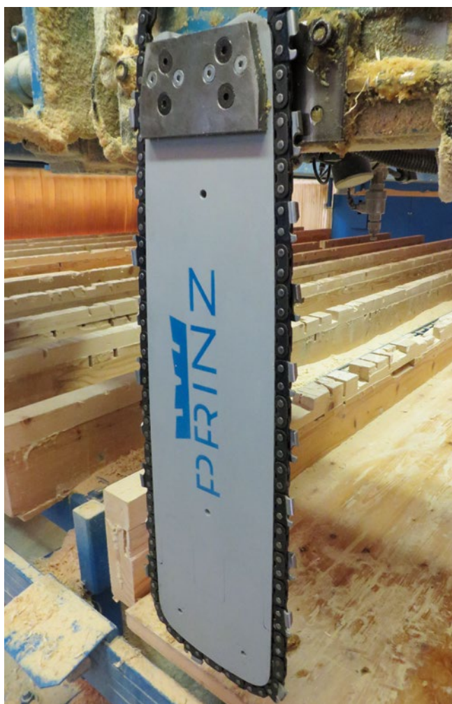
Prowadnice i łańcuchy stosowane w centrach obróbczych.
