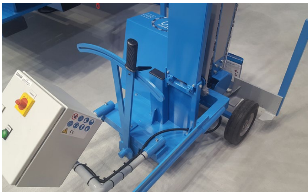
System do dokładnego ustawiania układu tnącego na linii cięcia.
