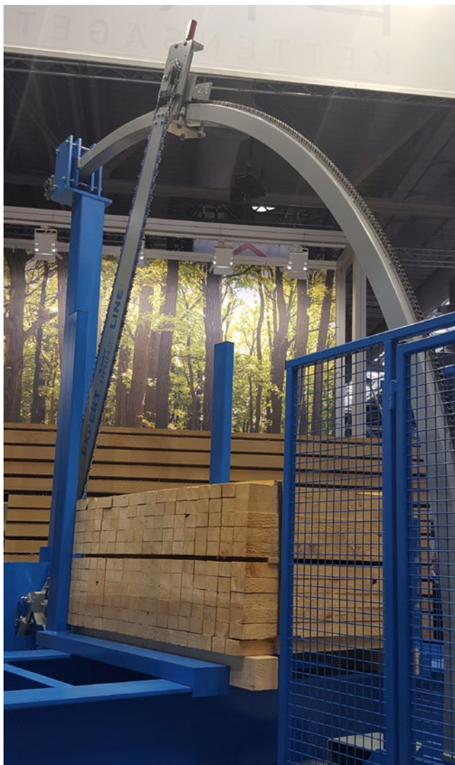
PC120 Double Action – kapowanie pakietu od góry i od dołu.
