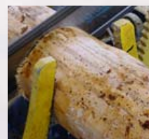
kleszcze zaciskowe przytrzymujące materiał przy cięciu
